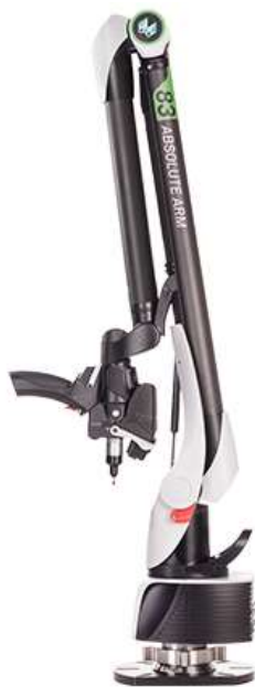
Fot.7. 7-osiowe ramię pomiarowe firmy Absolute Arm do pomiarów stykowych i skanowania.
