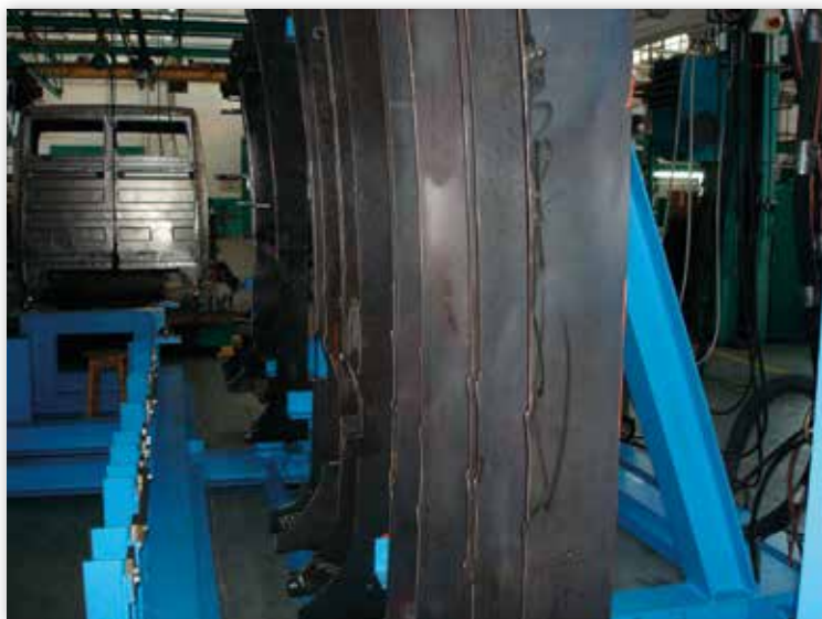
Fot. 2 Bazy przyrządu z fotografii 1 wycięte z blachy laserem. Dociski to rozpórki ze śrubą rzymską. Na drugim planie – kadłub nadwozia zgrzanego w przyrządzie.
