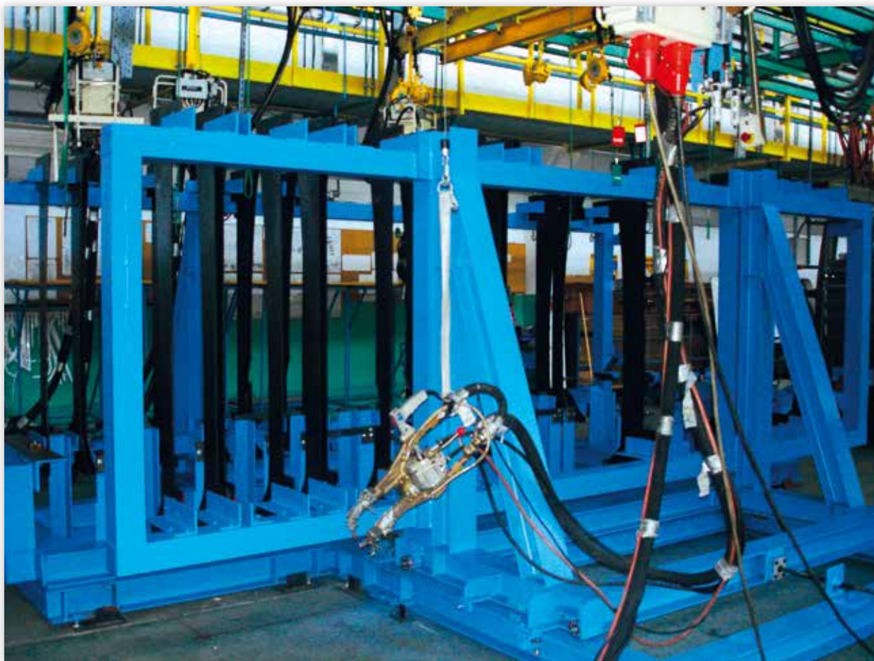
Fot. 1 Prosty przyrząd zmechanizowany do zgrzewania prototypów nadwozi samochodu dostawczego (małej liczby nadwozi np. 5 szt.), obsługiwany ręcznie
