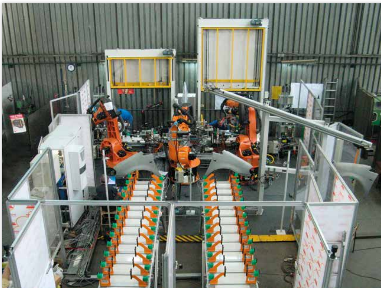
Fot. 3 Zrobotyzowane stanowisko produkcji błotników przednich samochodu: lewego i prawego. Załadunek i odbiór detali ręczny. Jest to najwyższy stopień mechanizacji ze sterowaniem półautomatycznym.
