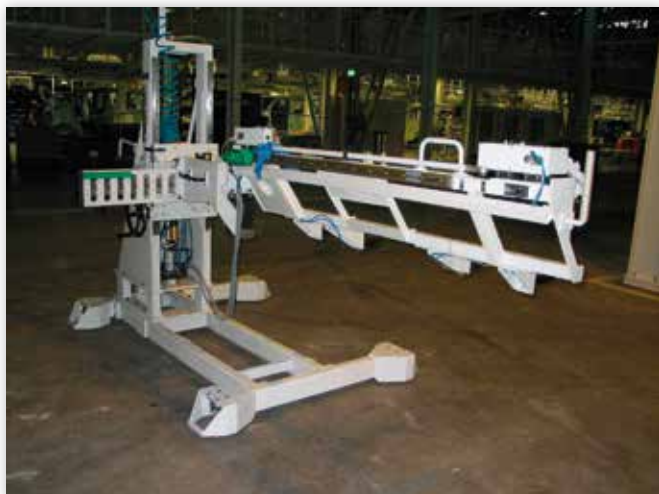
Fot. 4 Manipulator do montowania deski rozdzielczej w samochodzie, z napędem elektromechanicznym i pneumatycznym, obsługiwany ręcznie przez operatora. Przykład mechanizacji trudnej operacji technologicznej.
