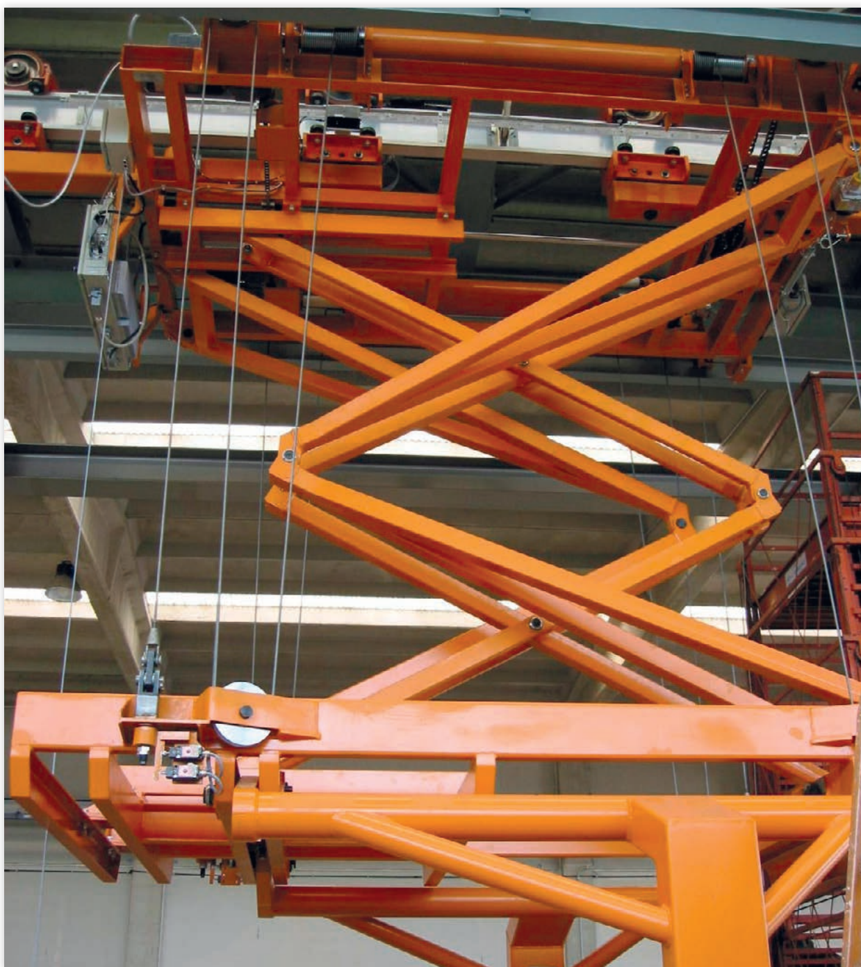
Fot. 2 Zawieszka opuszczana, zawieszona na torze EHB
