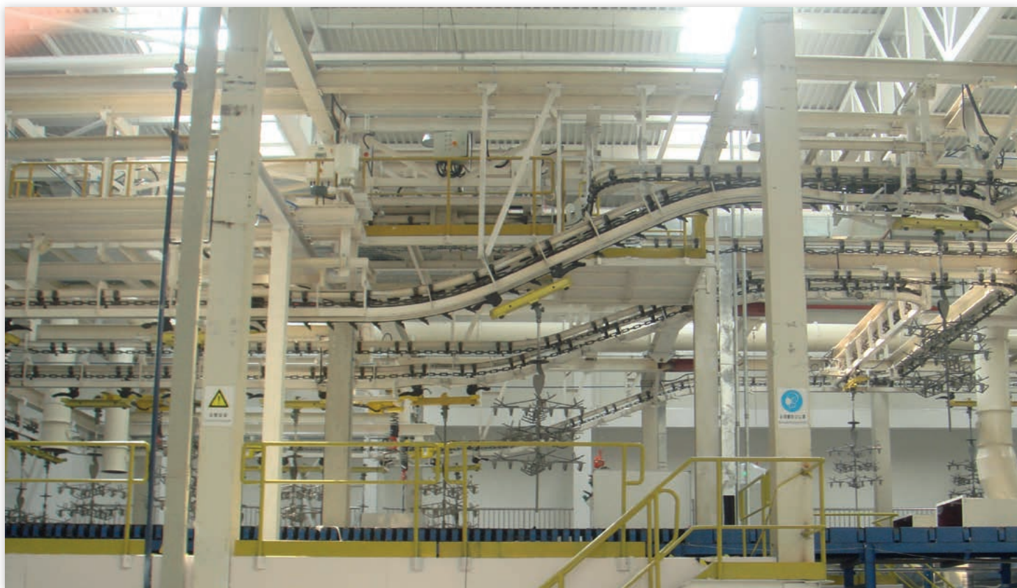
Fot. 1 Ogólny widok torowiska P&F; źródło: ROFA Industrial Automation AG
