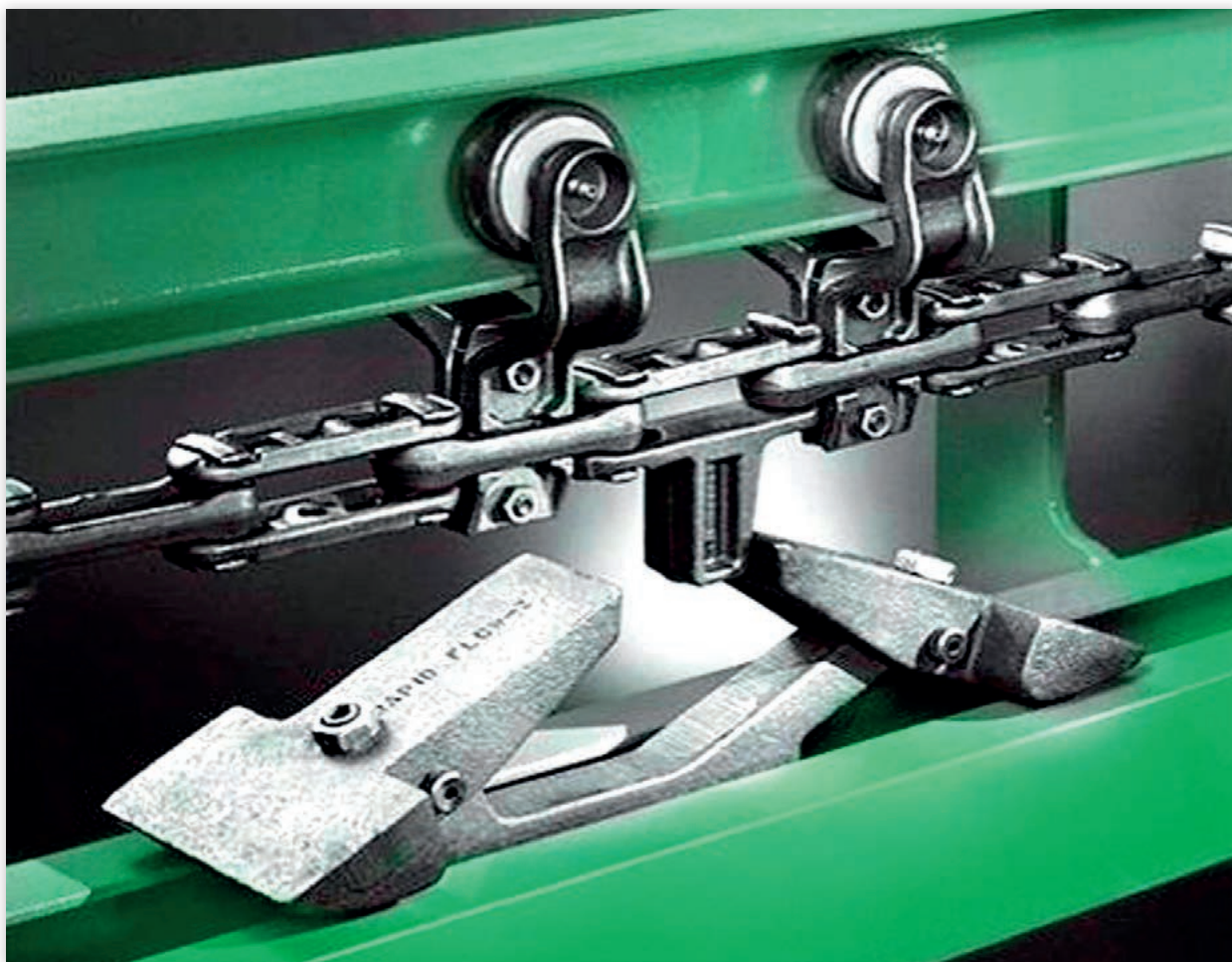
Fot. 2 Mechanizm sprzęgania łańcucha power z wózkiem free, firmy Rapid Industries
