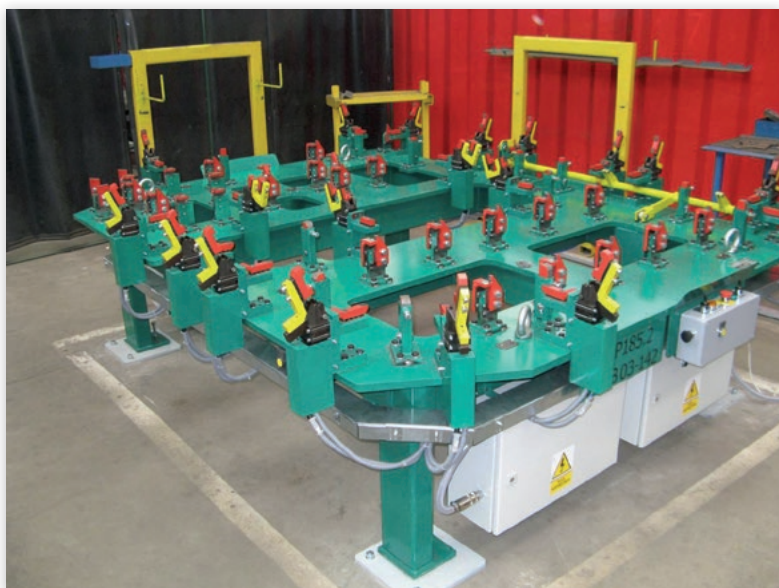
Fot. 2 Przyrząd spawalniczy z napędem docisków sprężonym powietrzem i sterowaniem elektropneumatycznym
