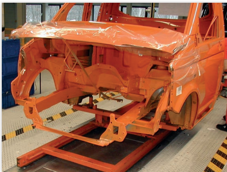
Fot. 1 Polakierowane nadwozie na skidzie – przenośniku saniowym
