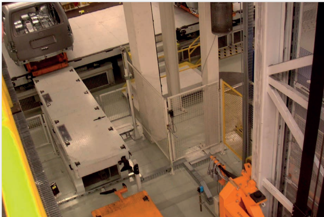
Fot. 6 Wyjazd z windy technologicznej. Widoczny zespół rolek wzdłużnych i transport poprzeczny pasowy.
