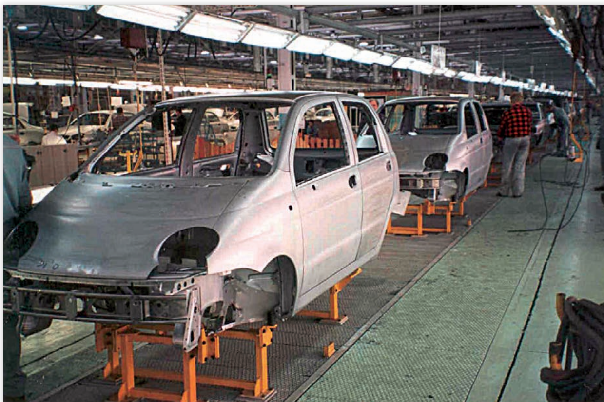
Fot. 1 Słat conveyor jako linia finiszowa w spawalni nadwozia
