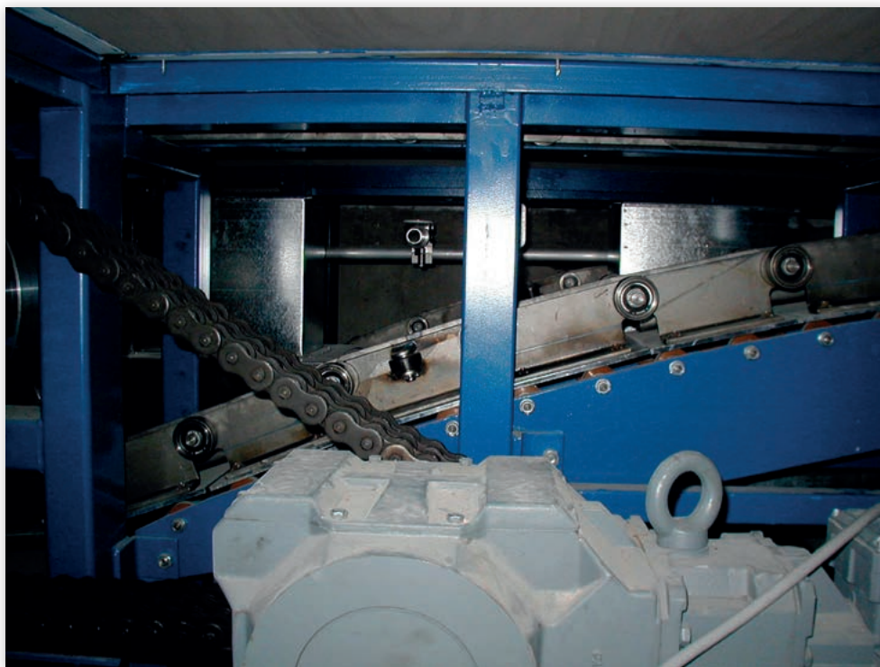
Fot. 5 Zespół napędowy i fragment łańcucha przenośnika – na drugim planie
