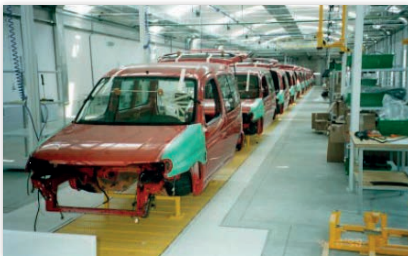
Fot. 2 Słat conveyor jako linia montażu głównego dla mniejszej serii produkcyjnej
