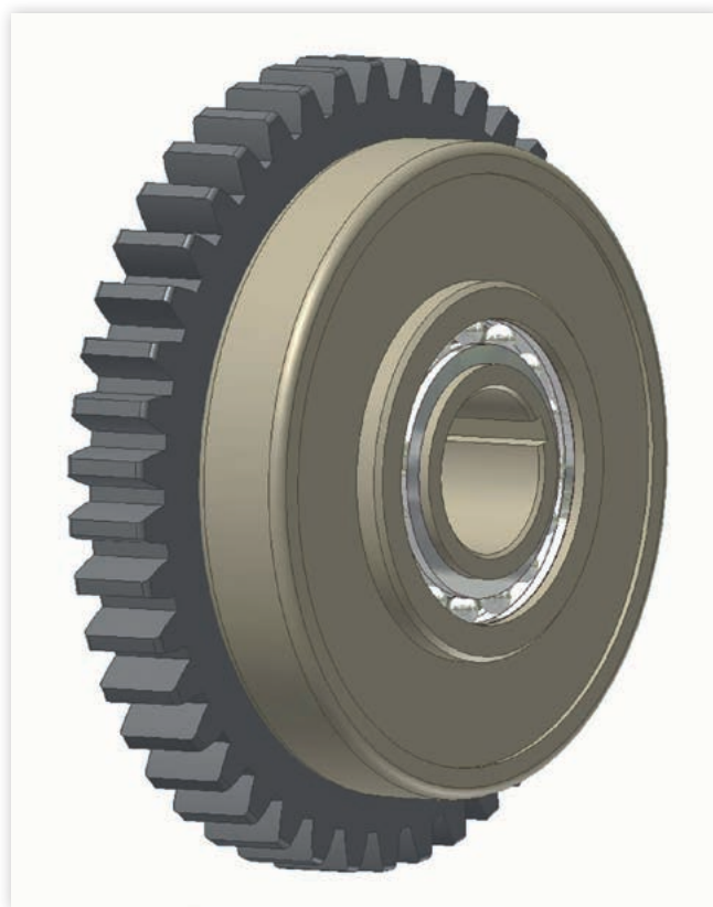
Rys. 1 Ogólny widok sprzęgła VHT z zamontowanym kołem zębatym
