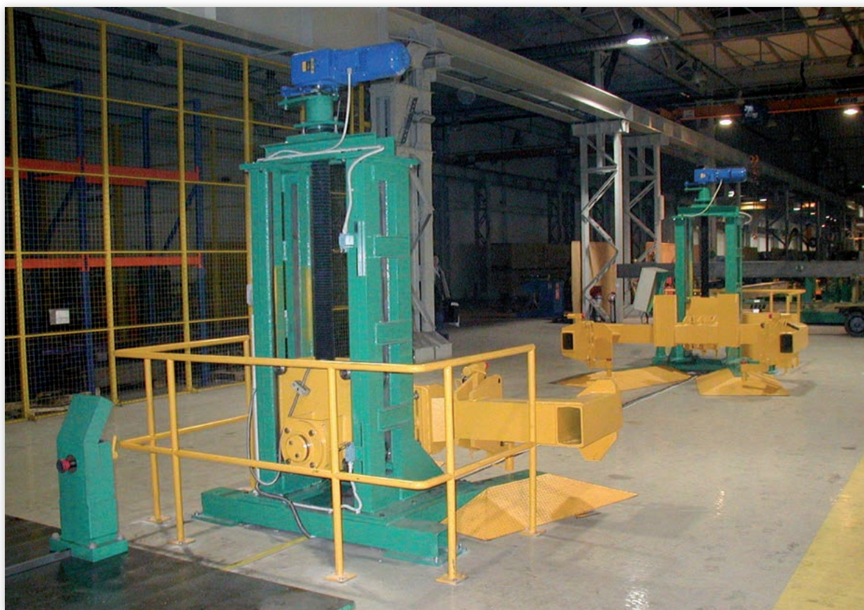
Fot. 1 Duży pozycjoner spawalniczy wykonujący obrót i podnoszenie za pomocą śruby dźwigowej. Na fotografii – bez zespołu spawanego.
