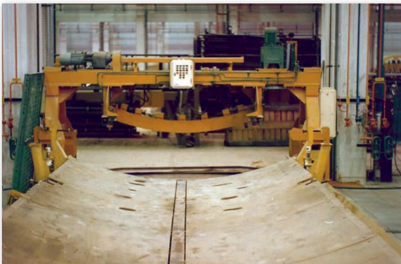
Fot. 4 Przyrząd do półautomatycznego spawania poszycia dachu wagonu
