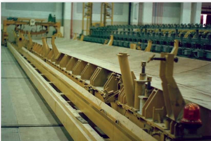
Fot. 3 Przyrząd – maszyna do spawania poszycia dachu
