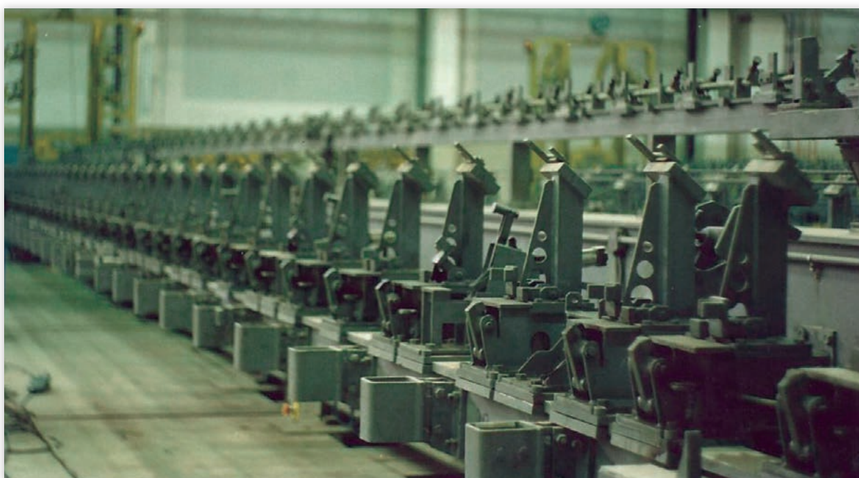
Fot. 1 Pozycjoner spawalniczy do spawania szkieletu dachu
