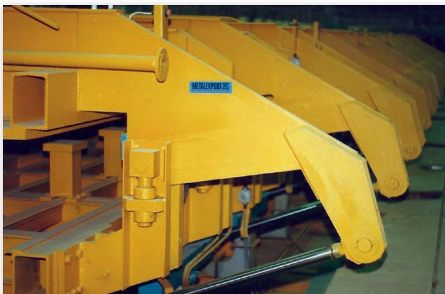
Fot. 5 Przyrząd do wypełniania poliuretanem ścian wagonu – szczególnie mocowania siłowników hydraulicznych
