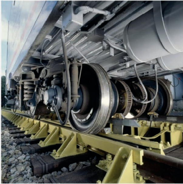
Fot. 3 Wózki z rozsuwnymi zestawami kołowymi SUW 2000, na specjalnym torze do rozsuwania zestawów kołowych
