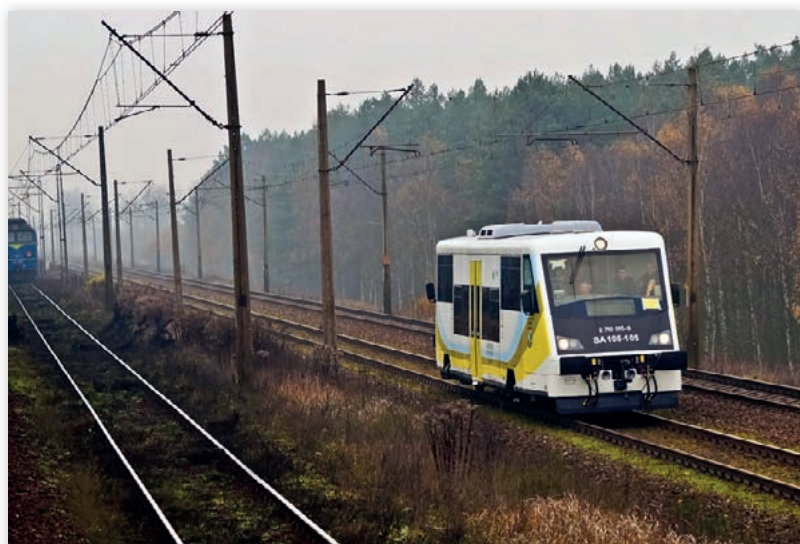
Fot. 1 Autobus szynowy SA 105, konstrukcji Ryszarda Suwalskiego z wózkami jednoosiowymi nowatorskiej konstrukcji. Najbliższy idei autobusu na szynach.
