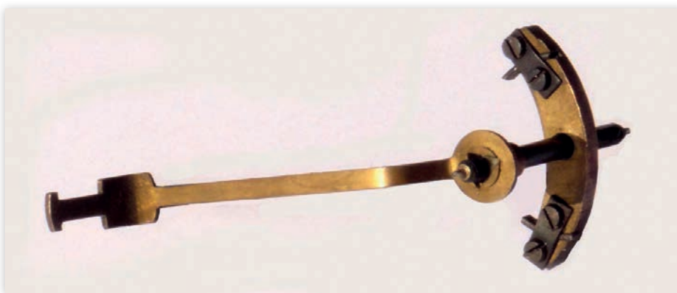
Fot. 2 Konstrukcja wychwyty Grahama wraz z elementem zawieszenia wahadła
