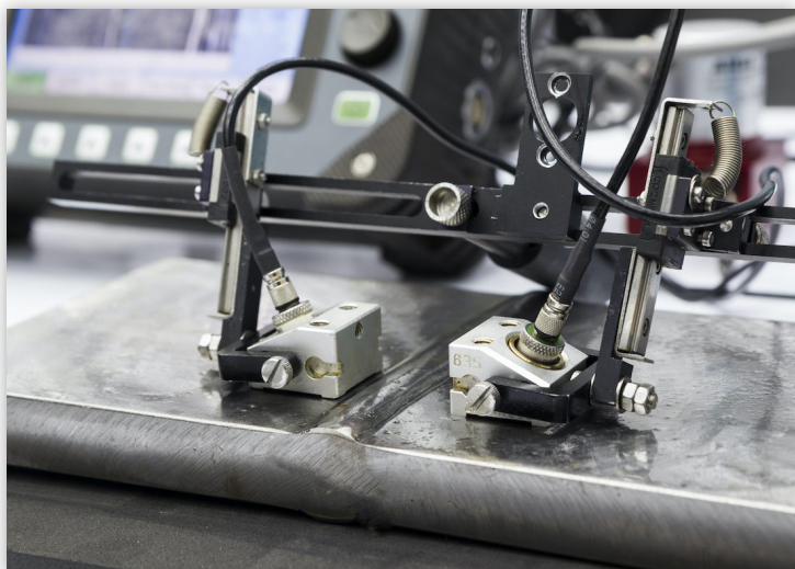
Badanie ultradźwiękowe UT
