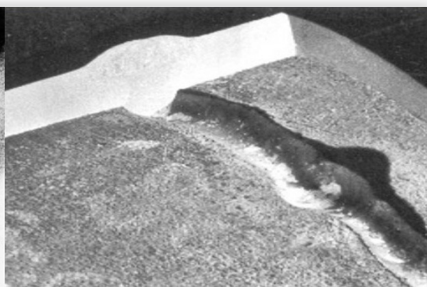
50mm Nadmierna penetracja – wyciek
