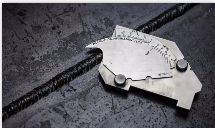
Uniwersalny, precyzyjny sprawdzian do spoin. Za jego pomocą bada się wielkość spoiny
