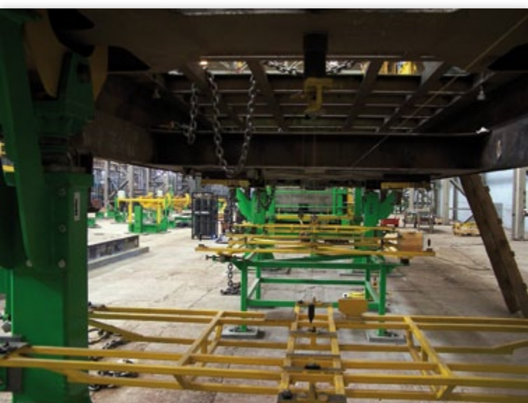
Fot. 6 Pomiar dużego korpusu przy pomocy przyrządu strunowego
