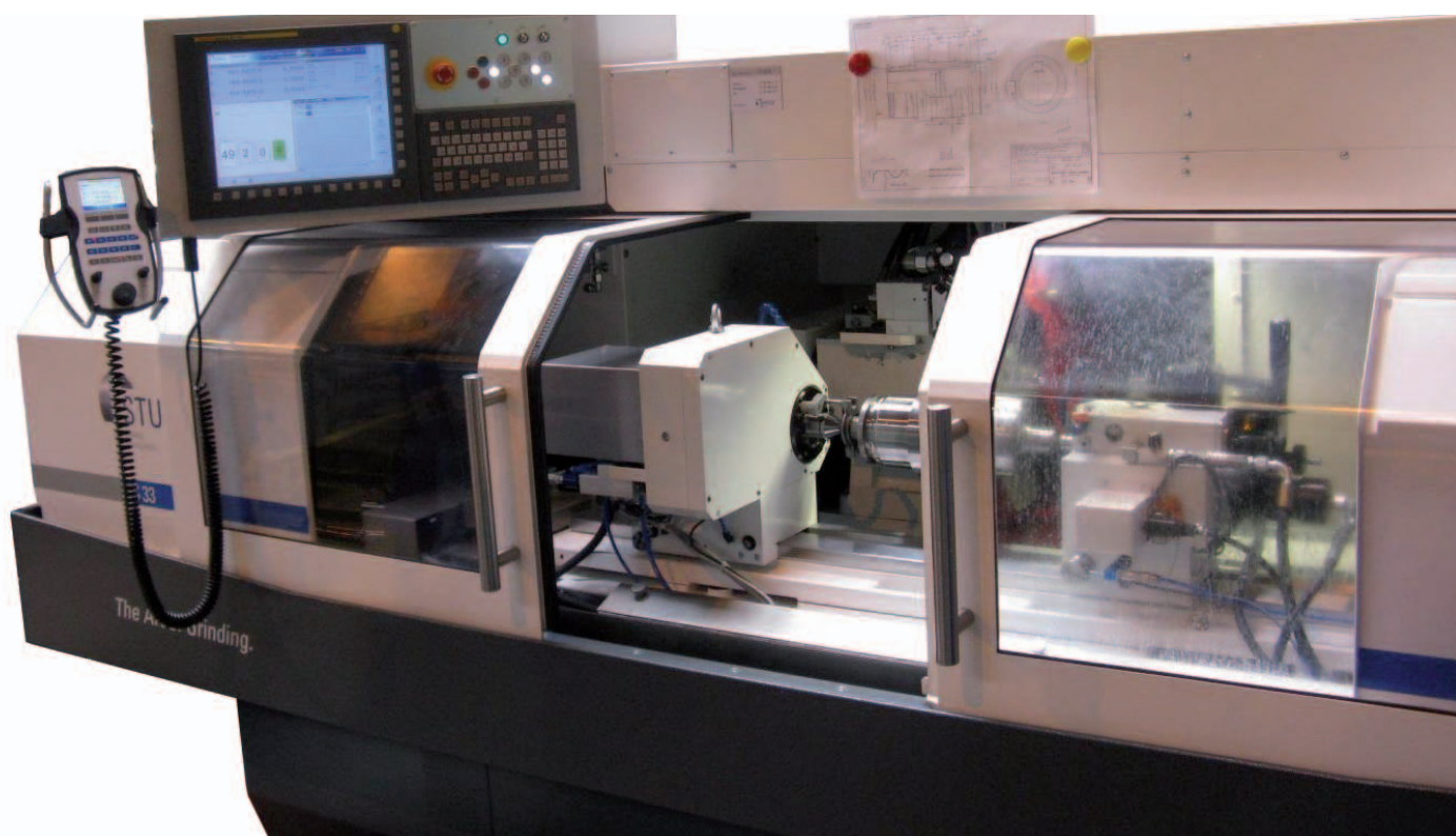
Fot. 2 Szlifierka Studer Granitan z łóżem z polimerbetonu na bazie granitu
