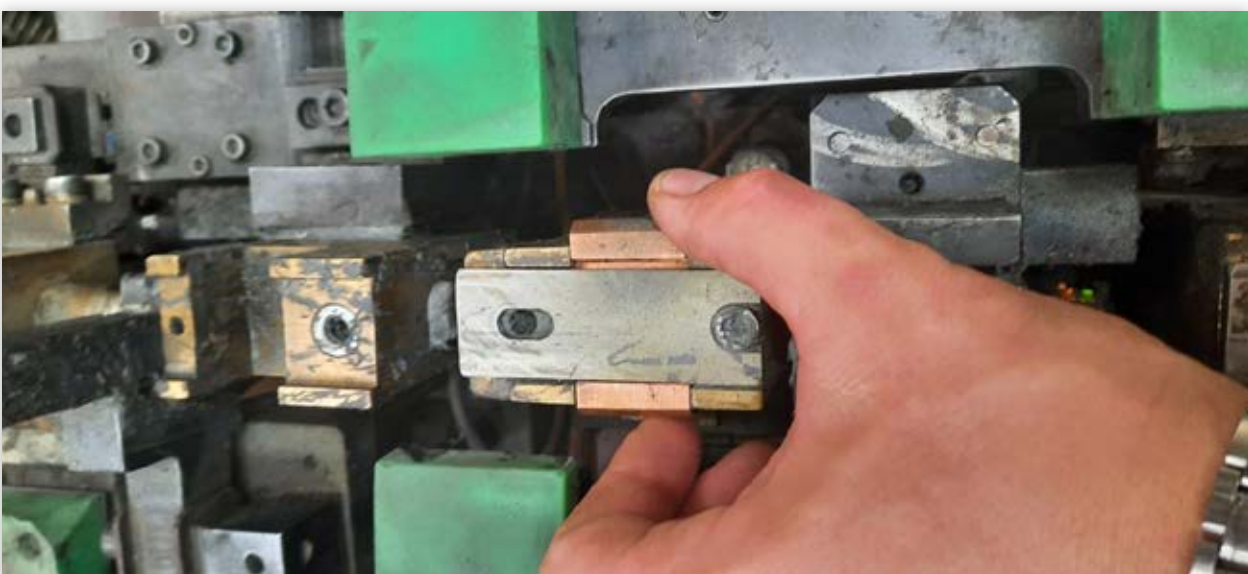
Widoczny luz pływakowej elektrody
