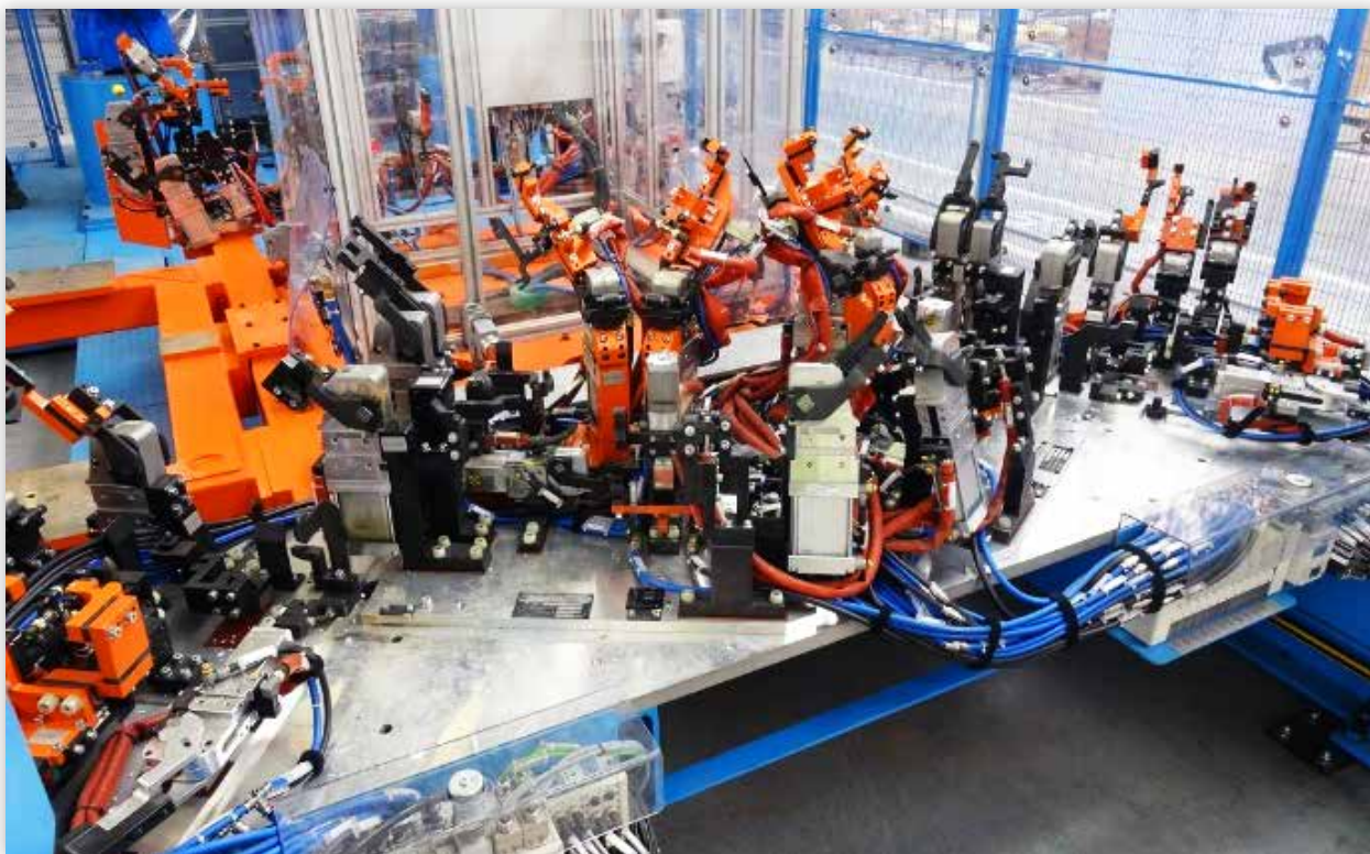
Rozbudowany przyrząd do zgrzewania dla stanowiska zrobotyzowanego
