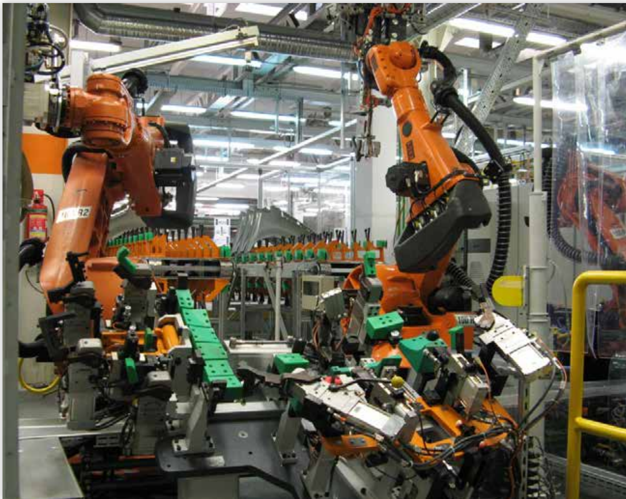
Przyrządy do zgrzewania nadkola samochodu na stanowisku zrobotyzowanym
