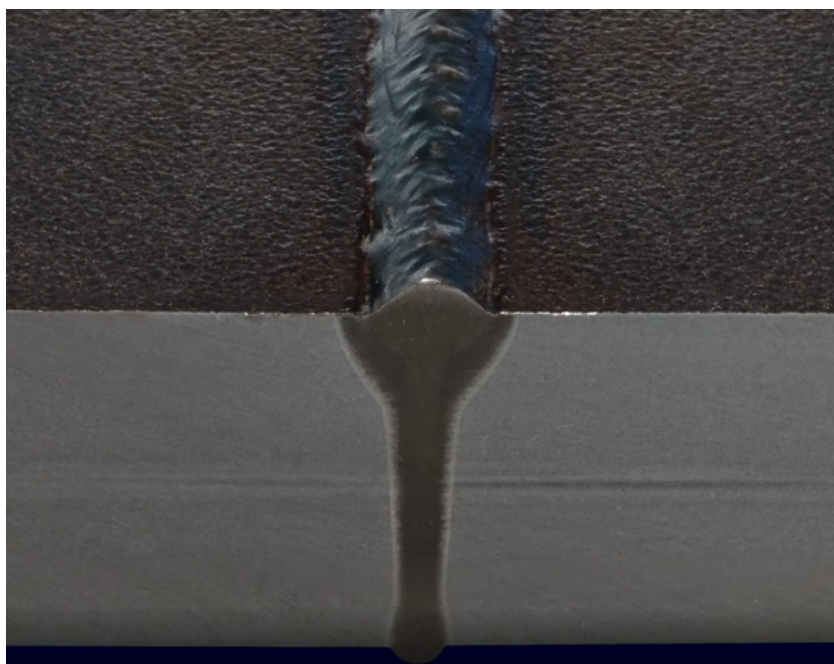
Zdjęcie spoiny wykonanej metodą hybrydową (źródło: Cloos)
