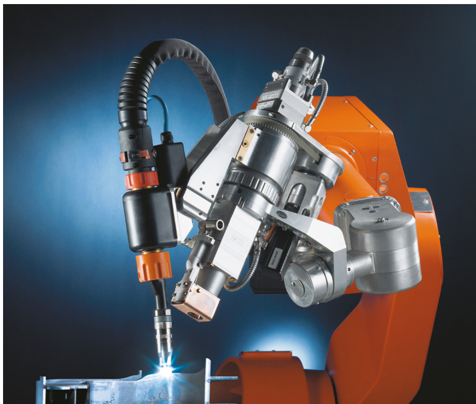
Zintegrowana głowica do laserowego spawania hybrydowego (źródło: Cloos)
