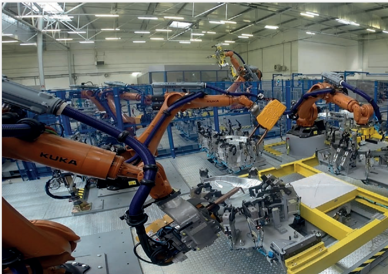
Fot. 2 Zrobotyzowane gniazdo technologiczne do wykonywania nadkola
